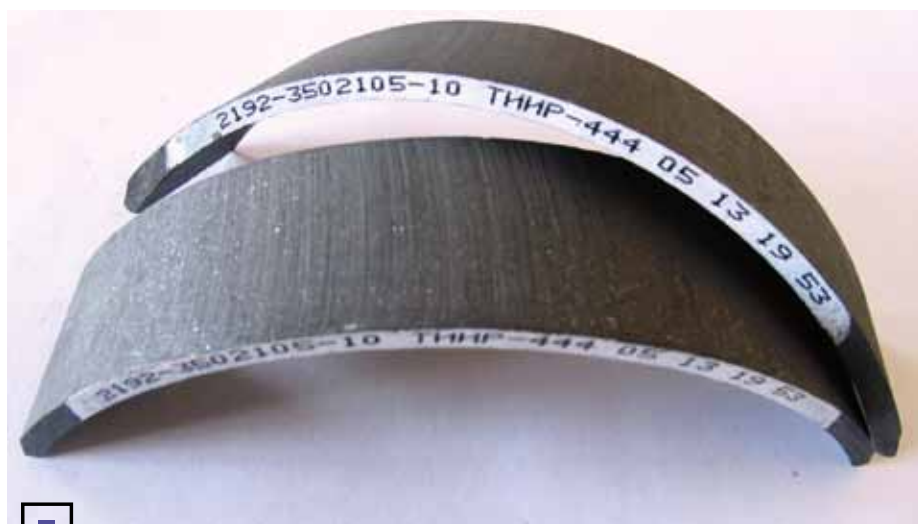
Новейшие фрикционные накладки «ТИИР» для барабанного тормоза последних моделей «ВАЗ»
