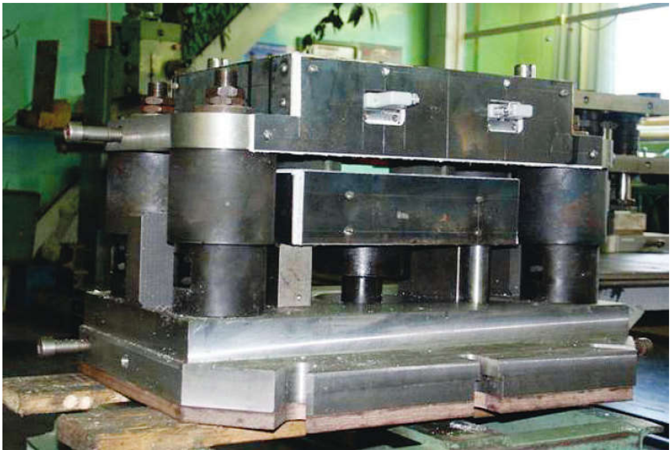
На прессах для изготовления дисковых колодок установлены двухгнездные пресс-формы, оборудованные индукционным обогревом
